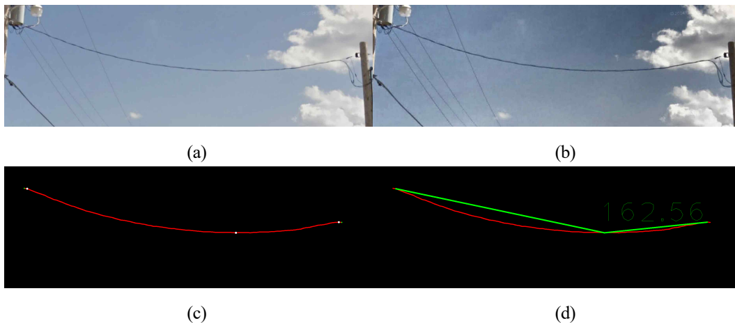
그림 9. 송전선 영상 전처리 후 각도 검출 기법: (a) Original Image (b) CLAHE를 적용한 이미지 (c) 제안한 방법으로 전선을 탐지 후, 0으로 마스크 한 이미지로 옮기고 양측의 최상단 점과 최하단점을 탐지한 이미지 (d) 그림 (c)에서 구한 각 점의 좌표와 아크 코사인을 사용하여 송전선 늘어짐의 각도 검출한 이미지
