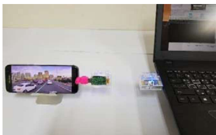
그림 6. mmWave 통신을 이용한 모바일 VR 플레이어 구현 (3840x1920 의 9 타일 중 1280x640 추출된 1 타일)
