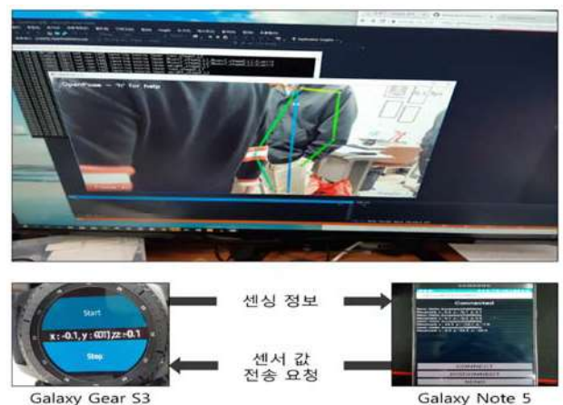
그림 7. 사람의 행동을 측정하는 OpenPose(위)와 웨어러블 기기를 통한 센서 정보전달 테스트(아래)
